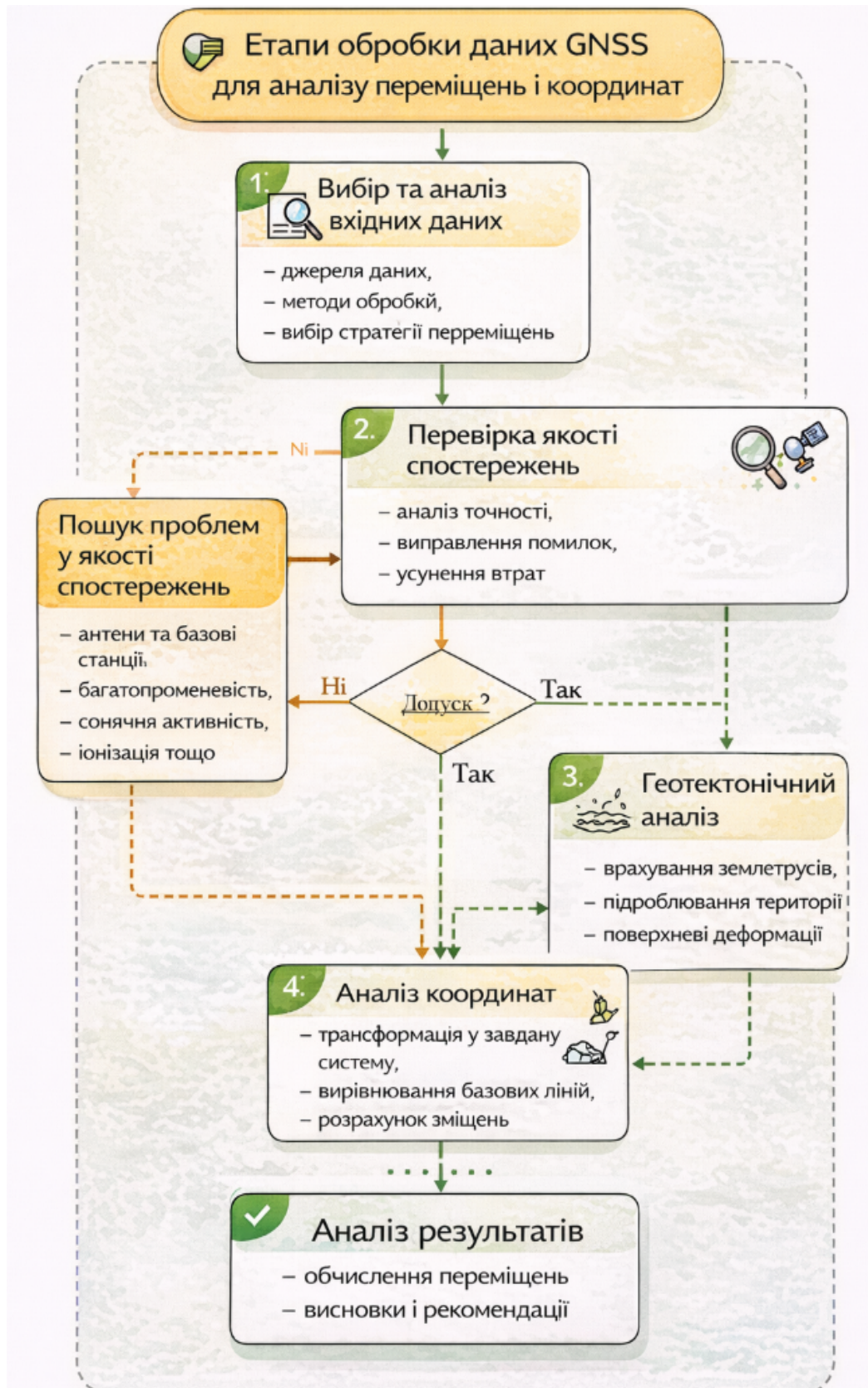
Рис. 5. Блок-схема визначення переміщень ГНСС-методом (розроблено авторами на основі [8])
