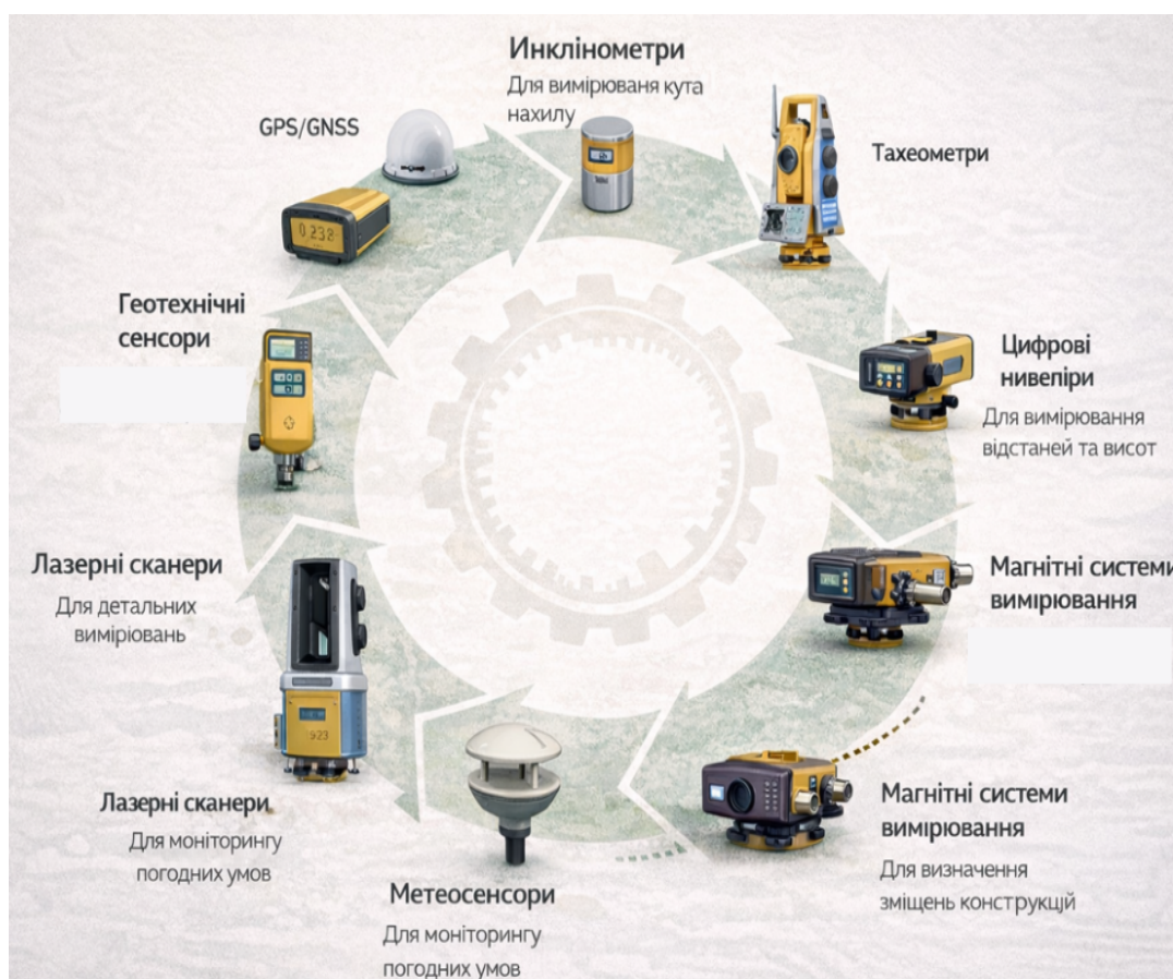
Рис. 6. Складові елементи системи геодезичного моніторингу DC3 (розроблено автором на основі [9])
