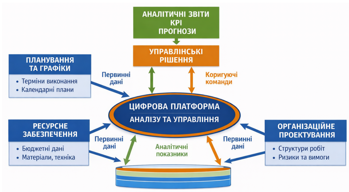
Рис. 3. Схема циркуляції інформаційних потоків у цифрово-орієнтованій системі підготовки будівельного проекту (розроблено автором на основі [3])
