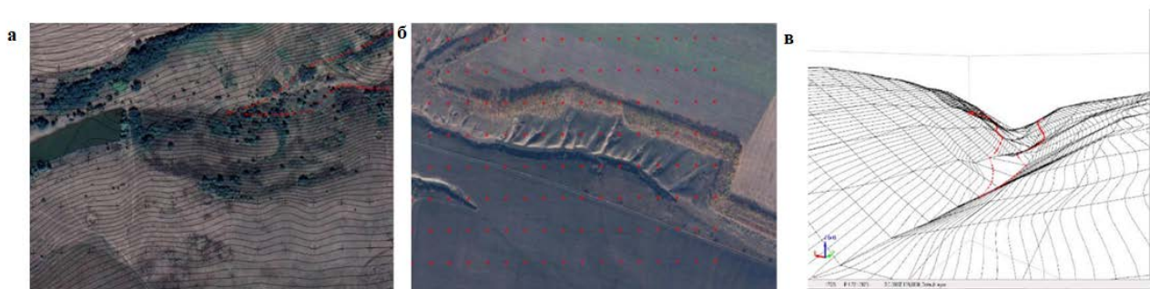
Рис. 1. Побудова 3D-моделі в програмі Digitala: а – цифрова модель розвитку дії зсуву на космічному знімку; б – Побудова моделі розвитку небезпечних екзогенних; в – 3D-модель розвитку зсуву. Джерело [2]
