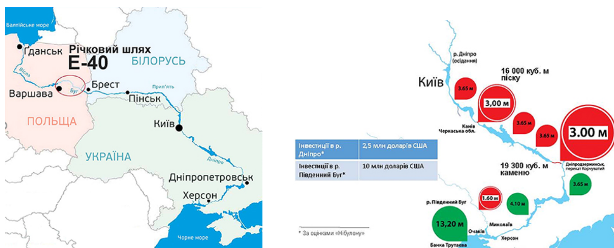
Рис.5. Схема річкового шляху E-40; вартість днопоглиблення Дніпра й Південного Бугу [14]
