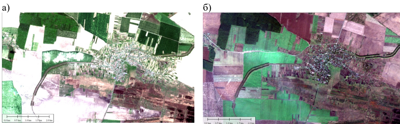
Рис. 9. Результати візуалізації в природних кольорах (компонент В04 - В03 - В02): а) до опрацювання, б) після опрацювання
