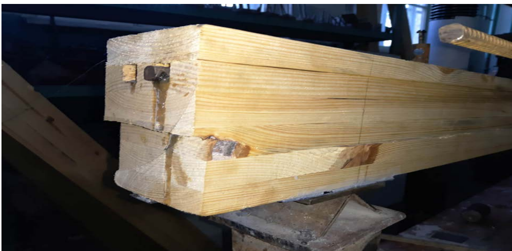
Рис. 4 Характер руйнування попередньо напруженої комбіновано армованої балки з клеєної деревини GRB-12 (Prst)
