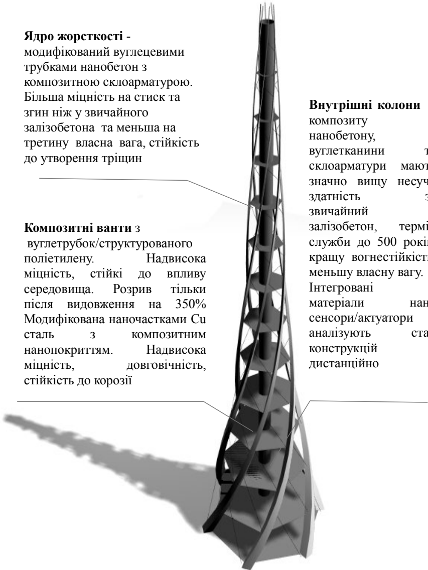
Рис. 2. Використання наноматеріалів в несучих конструктивних елементах висотного будинку на прикладі перспективного проекту
