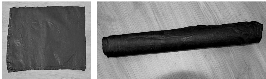
Рис. 3. Зовнішній вигляд екрануючого матеріалу на основі тканини та залізородного пилу.
